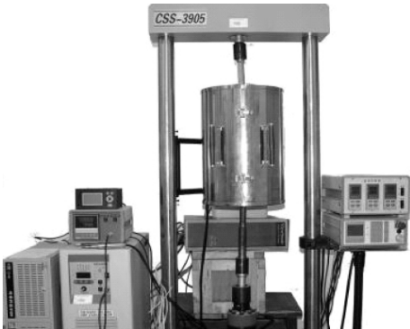
图 5 持久试验机、电阻炉
